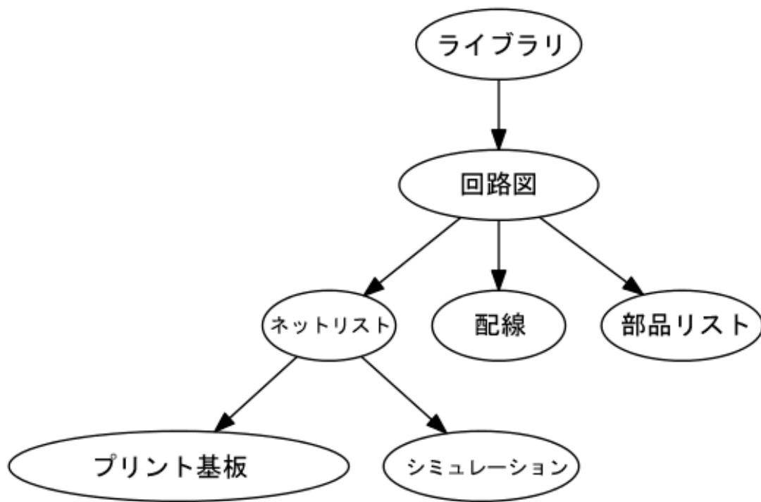
コンポーネントはコンポーネントライブラリから回路図へと配置されます。回路図が完成した後で、PcbNew が回路の接続情報とフットプリントをインポートできるように、ネットリストが作られます。
