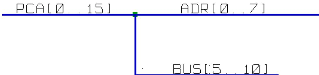
バス PCA[0..15], ADR[0..7], BUS[5..10] は互いに接続されています。（接続点に注意してください。縦方向のバスが横方向のバスの中央で接続されています。）
